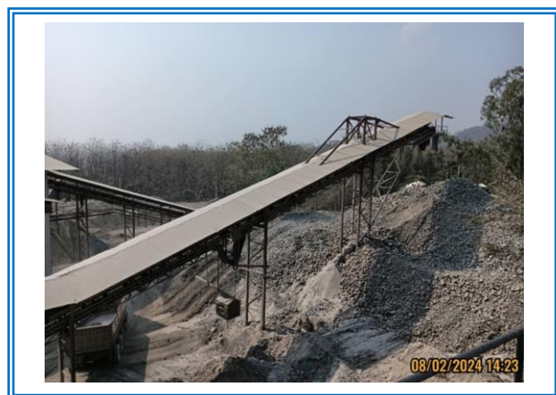
รูปที่ 3-13 สายพานลำเลียงแบบปิดคลุม
